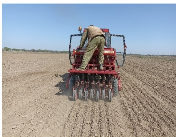
Рисунок 3 – Весенний и летний посев культур бразильской сеялкой Vencetudo SA-7300
