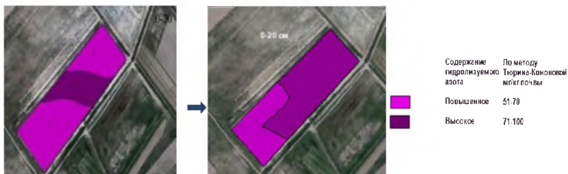
Рисунок 4 – Картограмма содержания азота в мг/кг почвы КХ «Кенжегара»
