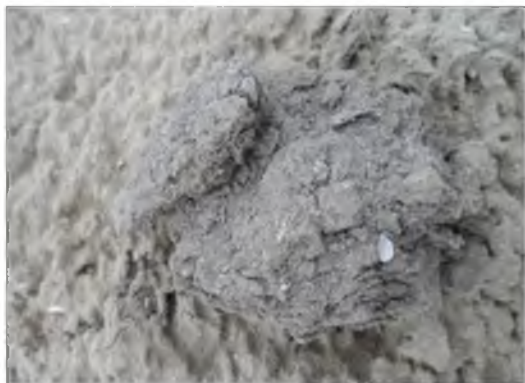
Рисунок 2 – Кусок распавшегося битума на рекультивационном участке 2012 года
