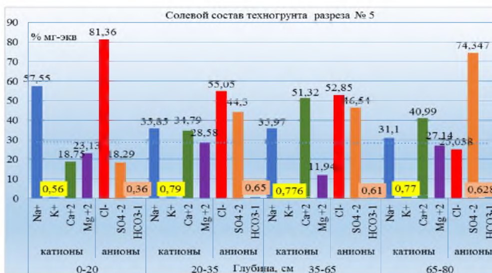
Рисунок 4 – Солевой состав техногрунта разреза № 5 на рекультивационном участке 2011 года
