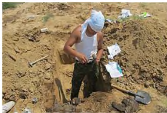
4-сурет – Ылғалдылық пен көлемдік массаны анықтауға топырақ үлгісін алу
