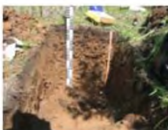
Рисунок 2 - Процесс формирования «молодой почвы» на гидроотвале, на хвостохранилище
