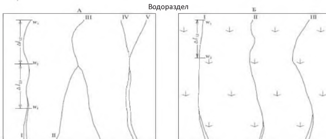
Рисунок 3 – Детальные измерения смыва почвы промерами водороин
